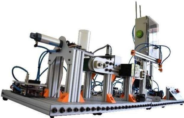
Incluye 1 correa transportadora con regulador de velocidad, 1 dispensador de piezas para diferentes materiales; tales como, plástico y metal. Adicionalmente, 4 émbolos neumáticos, uno para retirar la pieza del almacén, otro para recoger la pieza según selección de material, otro para simulador de estampado y otro para construir brazo de agarre neumático, fuente de poder 220Vac 50/60 Hz con salida 24 Vdc, baliza luminosa, 3 dispositivos MODBUS programables para tres de las etapas del proceso.
